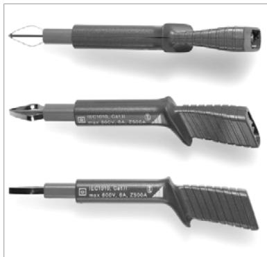
Drei selbsthaltende Prüfspitzen mit Berührungsenschutz zum Anschluss von Messleitungen mit 4 mm-Bananensteckern bzw. mit berührungs geschützten Steckern an Buchsen mit Öffnungen von 3,5 mm bis 12 mm, z.B. CEE-, Perilex-Steckdosen usw.
