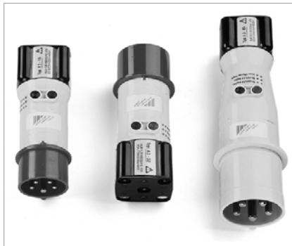
Die Drehstromadapter A3-16, A3-32 und A3-63 dienen dem problemlosen Anschließen von Prüfgeräten an 5-polige CEE-Steckdosen. Die drei Ausführungen unterscheiden sich durch die Größe des Steckers, der jeweils den 5-poligen CEE-Steckdosen mit den Nennströmen 16 A, 32 A, 63 A entspricht. Die Phasenfolge wird jeweils durch Lampen signalisiert.
